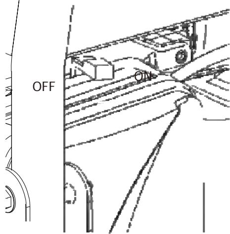
Para el arranque de retroceso, tome el asa de retroceso y tire lentamente hasta sentir resistencia aumentada. Tire rápidamente hacia arriba y lejos.
