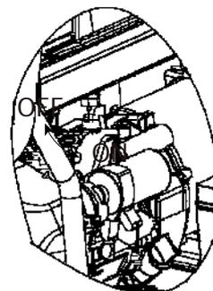
Mueva la palanca del estrangulador del motor a la posición OFF.
