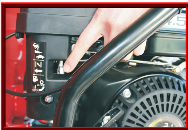
Fig. 50 Poner la palanca del aire del carburador, situada en el motor, hacia la izquierda "Cerrada". En caso de encendido con el motor caliente la palanca del aire debe permanecer en posición abierta.
